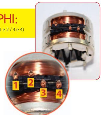
Hay una forma práctica de identificar a cuál sistema pertenece el actuador de ralentí: Si existe una cuña en el armazón del IAC (región del o'ring) este actuador posee conexión Delphi. Todos los otros actuadores, inclusive los del tipo snap-in, poseen conexión Marelli. Generalmente, la línea GM es del sistema Delphi. Líneas Fiat y Volkswagen son del sistema Marelli.
