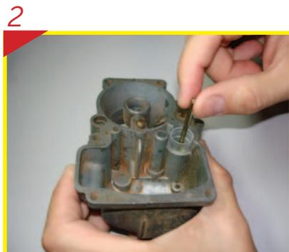
2 Centralize o pistão com o anel de proteção no poço do carburador e insira o pistão no interior do poço.
