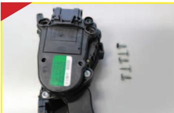
Retire os parafusos fixadores da tampa com muito cuidado para não danificar as garras metálicas que fazem contato com o cartão.
