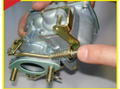
Para alterar o resultado, coloca-se mais ou menos arruelas de regulagem na haste da bomba de aceleração. Volume acima, remove arruelas, volume abaixo, adicione arruelas.
