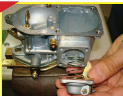
Em seguida, retire a tampa da bomba de aceleração para ter acesso ao diafragma e à mola de retorno.
