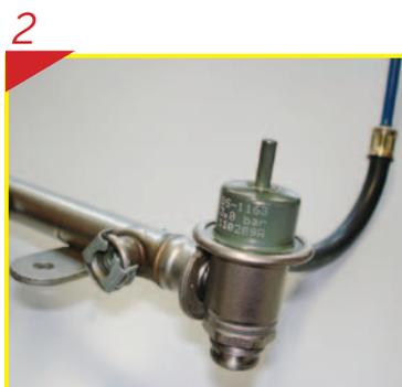
2 Na extremidade do tubo distribuidor (sistema multiponto)
