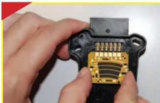
Coloque o cartão DS, seguindo a orientação dos contatos, segurando sempre pelas bordas. Evite ao máximo o contato dos dedos com as trilhas e com os condutores.
