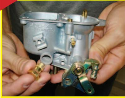
Desaperte o porta-gicleur e retire o principal, que controla a dosagem do combustível para a mistura correta, e depois, com cuidado, retire-o do alojamento. Não esqueça de trocar as juntas na hora da montagem.
