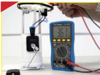
Agora, posicione a haste do sensor, simulando tanque vazio. O valor obtido deverá estar entre 359 e 367 Ω; Verifique também se não há perda de leitura entre as posições cheio/vazio.
