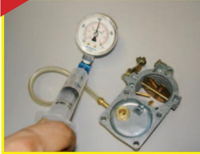
Faça agora o teste da válvula estilete: coloque 400 mm/Hg de depressão na bomba de vácuo e cheque o ponteiro, que não pode se movimentar por mais ou menos 30s.
