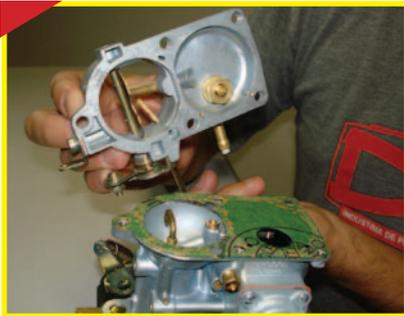
Remova a tampa do carburador e com cuidado retire a haste que liga a borboleta de aceleração.
