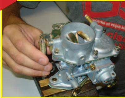
Retire o suporte e o filtro de ar, desconecte o cabo do afogador e as mangueiras e remova o carburador do motor. Depois, apoie a peça firmemente numa morsa ou dispositivo de fixação e comece o processo de desmontagem, retirando a mola de retorno do acelerador.
