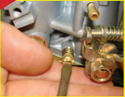
Com o carburador já montado no veículo, regule a marcha lenta da seguinte forma: primeiro ligue o motor até que atinja a temperatura de trabalho e verifique a rotação do motor.
