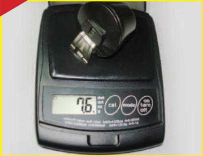
Para saber se a boia está ou não encharcada é necessário medir seu peso. Utilize uma balança de precisão e compare o resultado com a especificação do fabricante ou troque este componente.
