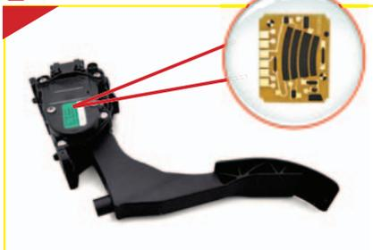
2. Pedal de aceleração com potenciômetro embutido (isento de cabo).
