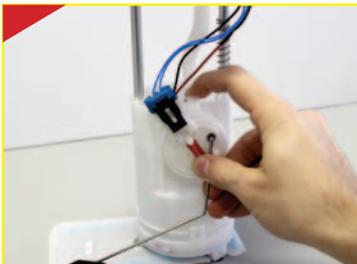
Retire o módulo de combustível do tanque e efetue a troca do sensor de nível danificado por um DS. Utilize uma bancada para efetuar o teste;
