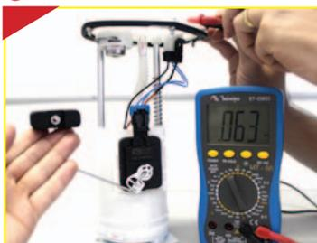
Mova a haste do sensor, simulando tanque cheio. O valor obtido deverá estar entre 59 e 67 Ω;
