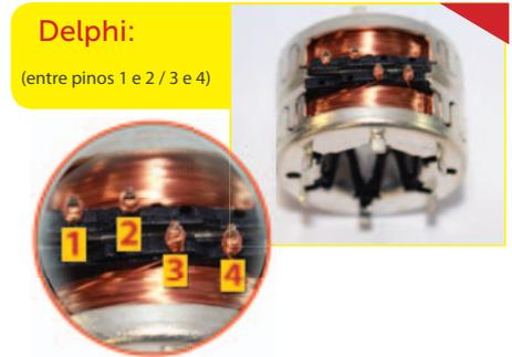
Existe uma maneira prática de identificar a qual sistema pertence o Atuador da Marcha Lenta. Se na carcaça do IAC tiver um calço na região do anel o-ring, este atuador é pinagem Delphi. Todos os outros atuadores, e isso inclui os do tipo snap-in, possuem pinagem Marelli. Geralmente, linha GM é sistema Delphi. Já as linhas Fiat e Volkswagen são sistema Marelli.
