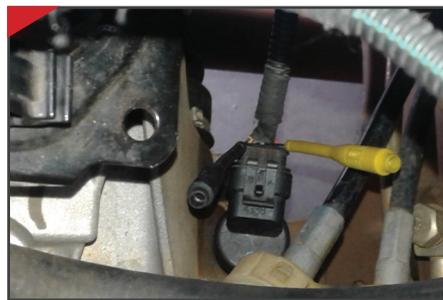
2º Analisar o Sinal do Sensor: Para analisar o sinal, você deverá utilizar um osciloscópio ou multímetro automotivo na escala de frequência Hertz (Hz), conferindo o sinal gerado nos pinos B e C.
