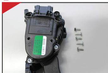
Retire os parafusos fixadores da tampa com muito cuidado para não danificar as garras metálicas que fazem contato com o cartão.
