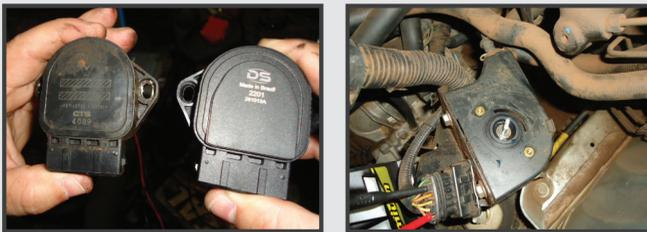
**7º Passo:** Ajuste o multímetro na escala de tensão contínua (20V) e confira os pinos 2 e 6. A tensão obtida deverá estar em 0.35 ( $\pm 0.05$  volts). Caso não esteja, gire a peça no dispositivo até encontrar a leitura.
