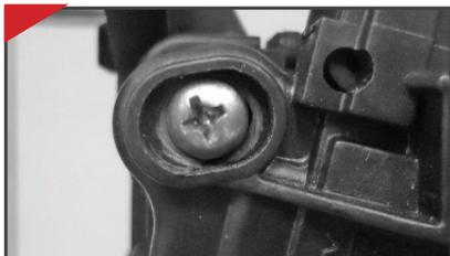
Posicione a tampa do pedal no centro do oblongo (posição ideal de ajuste). Ainda com o multímetro na escala VDC (tensão contínua) e a ignição ligada verifique o sinal do sensor conforme abaixo:
