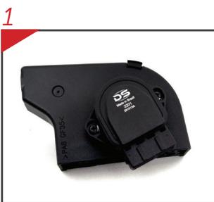
1. Sensor 2201 (Renault) ligado al cable del acelerador.
