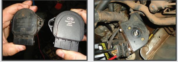
**7º Paso:** Ajuste el tester en el rango de voltaje DC (20V) y compruebe los conectores 2 y 6. La tensión obtenida debe ser de 0,35 ( $\pm 0,05$  voltios). Si no lo es, gire la pieza en el dispositivo hasta que se encuentre el valor;
