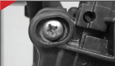
Posicione la tapa del pedal en el centro del espacio oblongo. (posición ideal para ajuste). Aún con el tester en la escala VDC (tensión de corriente continua) y la ignición encendida, verifique la señal del sensor como sigue:
