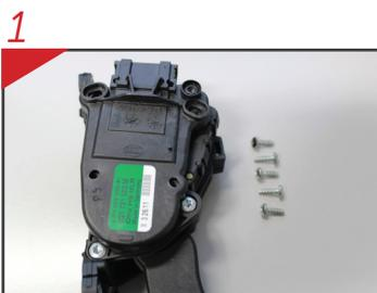
1. Quite los tornillos de fijación de la tapa con mucho cuidado para no dañar las garras metálicas que hacen contacto con la tarjeta;
