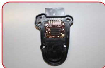
**4** - Coloque o cartão DS seguindo a orientação dos contatos, segurando sempre pelas bordas. Evite ao máximo o contato dos dedos com as trilhas e com os condutores.
