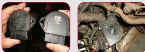
**7º Passo:** Ajuste o multímetro na escala de tensão contínua (20V) e confira os pinos 2 e 6. A tensão obtida deverá estar em 0.35 ( $\pm 0.05$  volts). Caso não esteja, gire a peça no dispositivo até encontrar a leitura.
