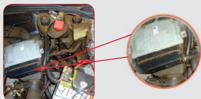
**6º Passo:** Instale o DS 2201 no centro do oblongo. Faça um aperto leve, apenas para encaixar a peça de forma que possamos girá-la no dispositivo. Conecte o chicote.
